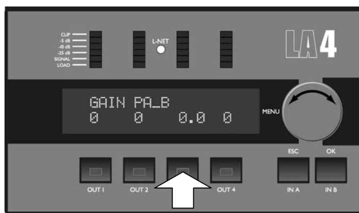
Figure 13 : Réglage du gain de sortie de la voie 3
