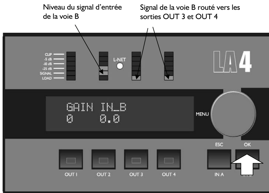
Figure 26 : Routage et niveau d'entrée du signal de la voie B pour le preset ARCS_SI I18_LO
