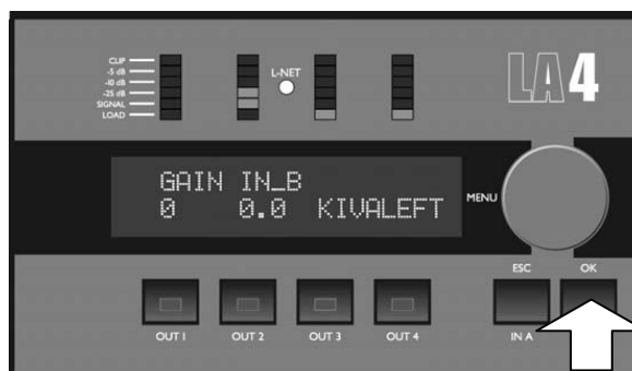
Figure 21 : Contrôleur faisant partie du groupe KIVALEFT
