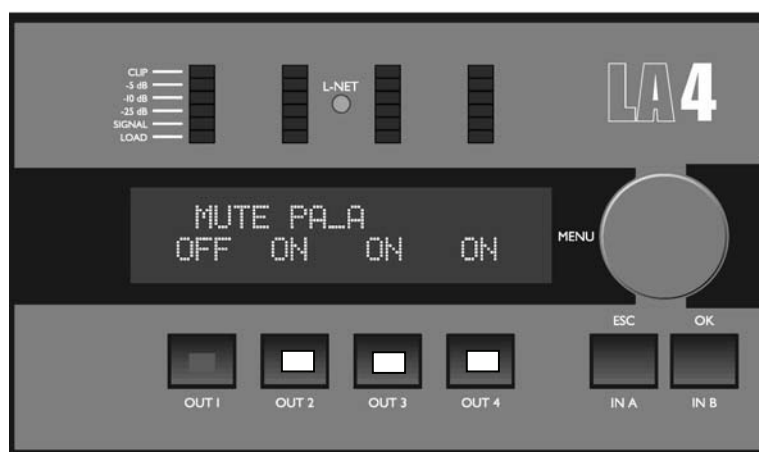
Figure 12 : Sortie 1 démutée, les autres mutées
